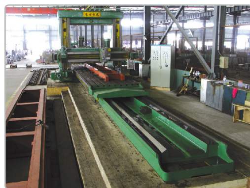
龙门铣刨床 最大刨削长度: 9000mm 最大刨削宽度: 2000mm
