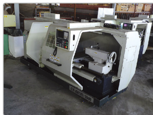
数控车床CY-K6180 床身上 \phi 800 mm、刀架上 \phi 520 mm FANUC系统
