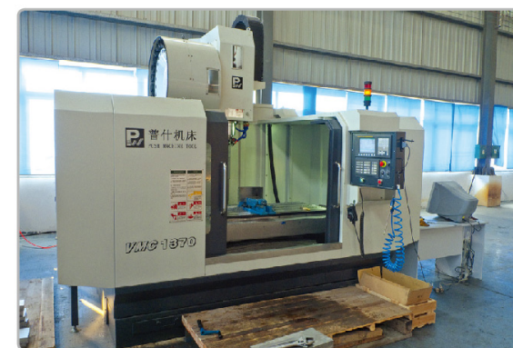
立式加工中心 工作台工作面宽度: 710mm 工作台工作面长度: 1400mm
