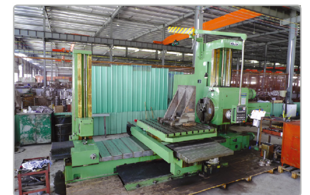
卧式铣镗床 镗轴直径 \phi 130 mm, 最大纵向行程1600mm 横向行程1600mm, 数显控制。
